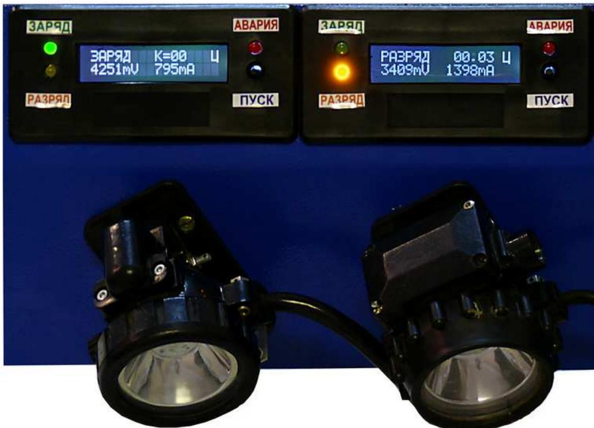
Буква «Ц» обозначает, что включен режим контрольного цикла для определения емкости АБ, а выражение «K=XX» или «N=XX» (в зависимости от версии программы) показывает количество законченных циклов (где XX – количество).
